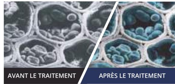
Notre procédé pétrifie l'intérieur des cellules en tapissant leurs parois de particules de Ceramix®, en imprégnant les fibres de résine phénolique et enfin en compressant l'ensemble. La cristallisation des cellules et des particules nutritives par la Ceramix® évite d'attirer les bactéries, les champignons, les insectes et les micro-organismes, et permet donc l'utilisation de dassoCTECH dans les environnements exposés.
