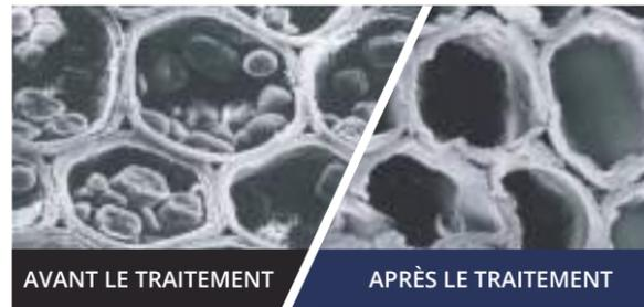
Notre procédé de thermo-traitement unique, protégé par un brevet, permet d'extraire les glucoses et amidons des fibres de bambou et de les remplacer par des résines phénoliques (13%). Puis les fibres ainsi imprégnées sont compressées afin de créer un nouveau matériau, très dense, dur et résistant qui repousse toutes les attaques de bactéries, champignons, insectes et micro-organismes.
